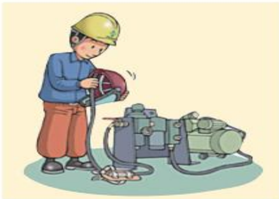
3 중압호스를 유압조절장치 및 여과장치에 연결하고 연결관을 안면부 및 유량조절장치에 연결
