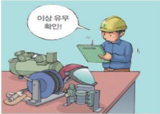
1 압축공기 공급원, 중압호스, 유량 조절 장치, 안면부 등의 이상 유무를 확인
